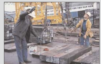
Der stumme Austausch zwischen Anschlägern und Kranführer setzt deutliche Gesten und ständige Aufmerksamkeit voraus.
